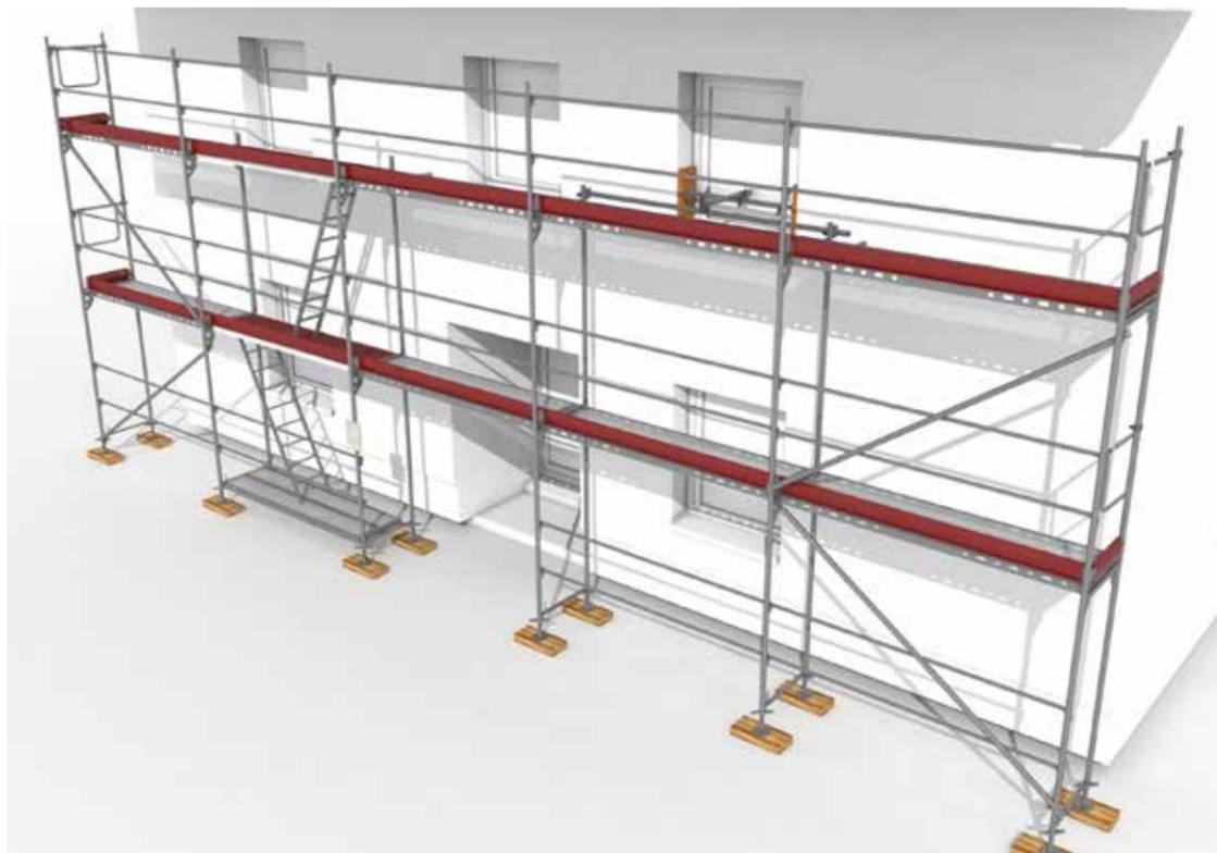
Un échafaudage de pied est une construction provisoire servant de moyen d'accès et/ou de poste de travail en hauteur (ex. : travaux de maçonnerie, de façade, de toiture, de peinture, de nettoyage...). De cette définition, découlent les caractéristiques d'un échafaudage adéquat et conforme :
