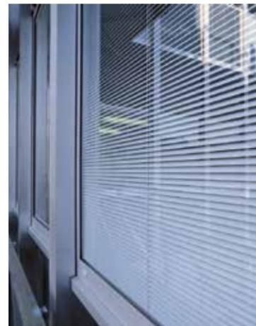
Le double vitrage thermique Climaplus Screen fabriqué par Saint-Gobain intègre un store vénitien à lamelles orientables et relevables manuellement ou automatiquement, disponible en 9 teintes et 3 largeurs de lamelles de 20 à 27 mm. Il peut être posé en façade rideau, en cloisonnement de bureaux et adapté aux menuiseries de fenêtres et vérandas.
