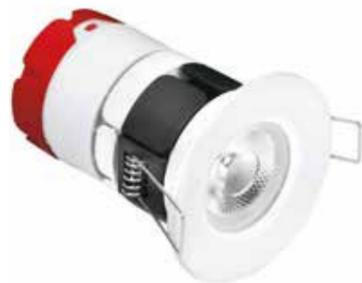
La version fixe ou basculante du spot mPro fabriqué par Aurora peut être encastrée dans les plafonds de toutes les pièces, même humides et est compatible avec tout type d'isolants roulés, soufflés ou projetés. Il offre un rendement jusqu'à 660 lm pour 7 W consommés et des températures de couleurs de 3 000 ou 4 000 K. Équipé d'un driver détachable, il peut se poser en faux plafond jusqu'à 47 mm d'épaisseur.
