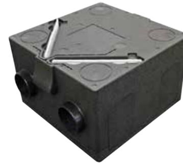
l'énergie contenue dans l'air extrait pour préchauffer l'air ambiant avec une consommation de 26 W-Th-C et un débit de 13 m<sup>3</sup>/h. Elle possède un moteur basse consommation deux vitesses à commutation électronique, des caissons motorisés à turbines haut rendement et un échangeur thermique à flux croisés intégrant un by-pass automatique. Sa classe de filtration: M5 sur air neuf.
