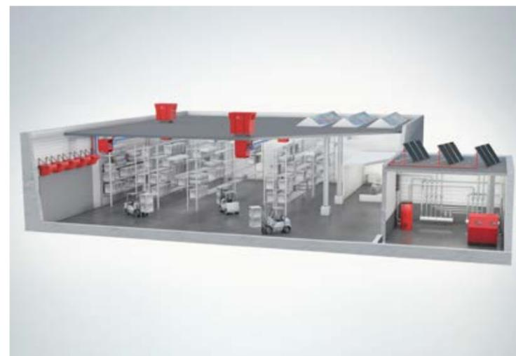
Modèle fonctionnel de la solution Hoval « chauffage des grands volumes » avec un générateur de chaleur et un appareil de chauffage décentralisé par circulation d'air.
